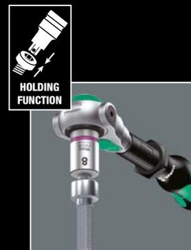
El aprisionamiento del tornillo hexagonal interior en el extremo de la herramienta se garantiza por medio de una bola elástica.
