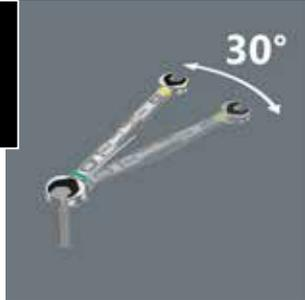
Au lieu des 60°, Joker offre un angle de reprise de 30° couplé à un mécanisme dodécagonal. Ce qui, en conjugaison avec sa tête droite, rend superflue l'inversion de la clé. Avec Joker, vous pouvez désormais desserrer, contre-serrer et retirer vis et écrous dans des situations où les outils
