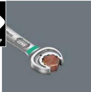
L'ingénieuse géométrie dodécagonale de Joker engendre une liaison géométrique intime avec la vis ou l'écrou – une liaison qui tient ! Et la plaque interchangeable en métal trempé située dans la fourche de Joker « enserre » littéralement la vis de ses pointes extrêmement dures. Deux atouts permettant d'éviter tout dérapage malencontreux, même lors de serrages avec couples élevés.
