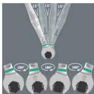
Le coudage à 7,5° du côté fourche, la forme dodécagonale et l'ajustement de l'utilisation (positionner, visser, tourner, positionner, visser, tourner, etc.) permettent de visser même dans des situations où l'angle de reprise ne peut pas excéder 30°.
